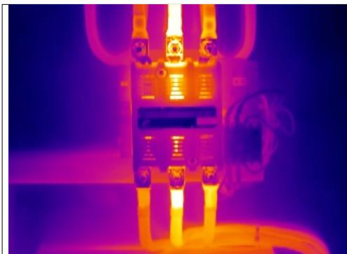
Este termograma nos muestra la evolución de una simple falla de ajuste de bornera que termino por dañar los contactos internos del contactor.
